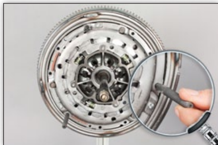
Fig. 5: Tapbouten van het SAC-gereedschap met de hand indraaien totdat u een lichte weerstand voelt; hierbij geen gereedschap gebruiken
