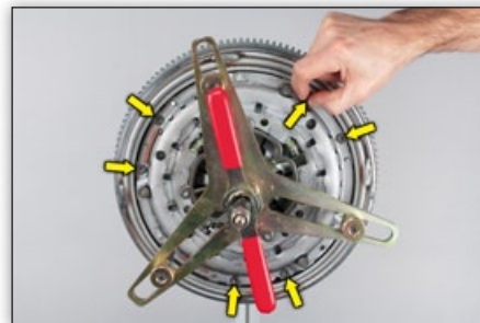
Bild 7: De meegeleverde bouten met de hand in de 6 beschikbare schroefdraden indraaien. Vervolgens met 10,5 \pm 1 Nm vastdraaien
