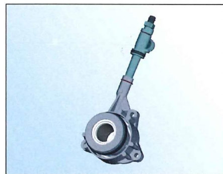
Figuur 2: Hydraulisch druklager met ont-luchter in de hydraulische leiding.
