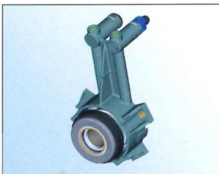
Figuur 1: Hydraulisch druklager met aparte leiding voor het ontluchten.
